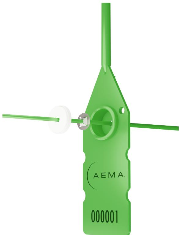
Sello de seguridad tipo banda circular. Robusto mecanismo de cierre con inserto de acero inoxidable el cual cuenta con 4 puntos de anclaje los cuales ejercen presión de forma independiente para evitar manipulación. Fácil ajuste manual e instalación sencilla. Fabricado en polipropileno copolímero.
